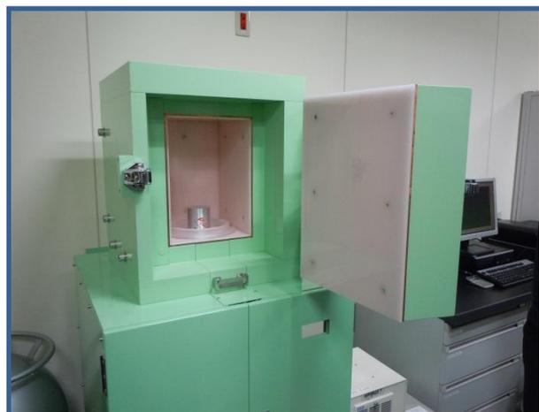
極微量かつ多種類の放射能を、きわめて高い精度で測定することができるゲルマニウム半導体検出器
